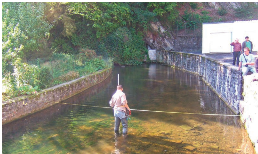
Fig. 3. Jaugeage à la résurgence de l'Eau Noire (Nismes) pour mesurer les vitesses d'écoulement et pouvoir exprimer le débit en fonction de la hauteur de la colonne d'eau.
