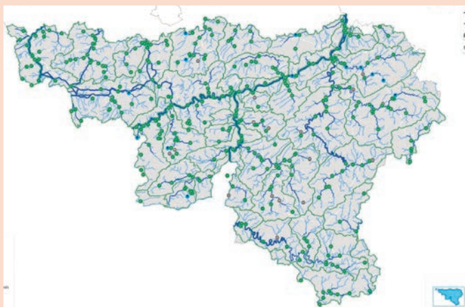
Fig. 17. Portail WalHydro situant les équipements de mesure du débit des cours d'eau gérés par le Service Mobilité et Infrastructure et le SPW ARNE
