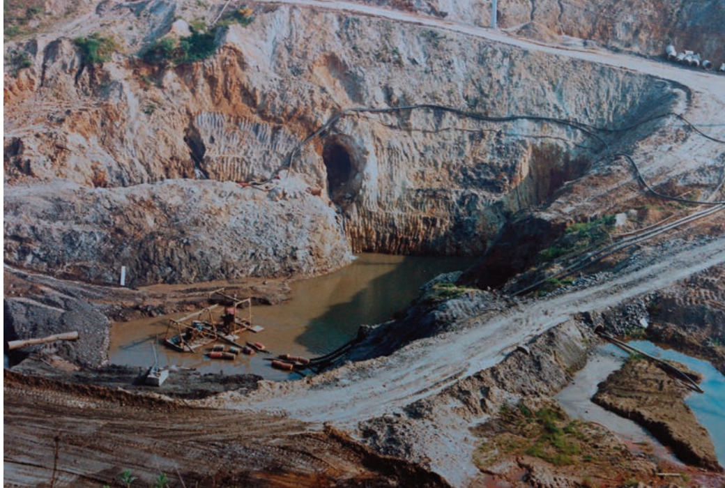
Fig. 2. L'exploitation à fond de gisement (+/- 45m de profondeur) en contact avec les argiles wealdiennes noires et par endroit avec le calcaire (que l'on ne voit pas car les affleurements sont dans l'eau). On devine les pontons avec les pompes d'exhaure mis en place pour pouvoir exploiter la barytine sous le niveau de la nappe (Photo J. Counet).
