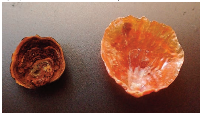
Fig. 4. Comparaison entre la coque supérieure d'IRSS provenant du tunnel de Godarville (à gauche) et d'un coquillage ramassé sur une plage en Bretagne (à droite).
