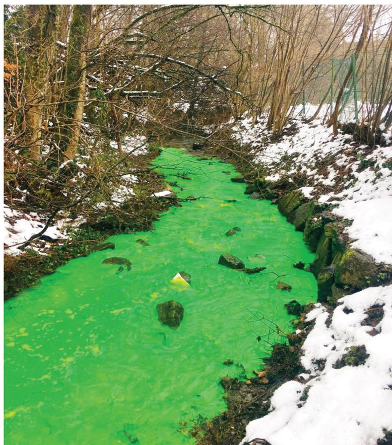
Fig. 10. Quelques mètres en amont du Rouge-Thiers, le ruisseau du Fond Bastin au moment du traçage à l'urarine le 27 janvier 2021. Les pluies et la fonte des neiges qui ont suivi l'injection sont à l'origine de la crue (poussée de turbidité visible en fig. 8).
