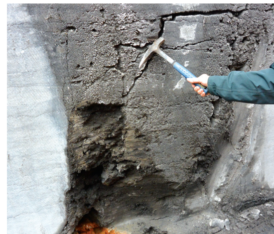
Fantôme de roche à la carrière de Gauthier-Wincqz (Soignies). La couleur sombre signale la teneur en eau dans la porosité de l'altérite. L'aspect granuleux provient des entroques composant l'altérite résiduelle.
