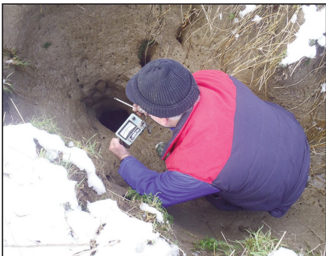
Contrôle à l'anémomètre du courant d'air et de la température au dessus de la cheminée sondée sur 5m au fond de Her3.
