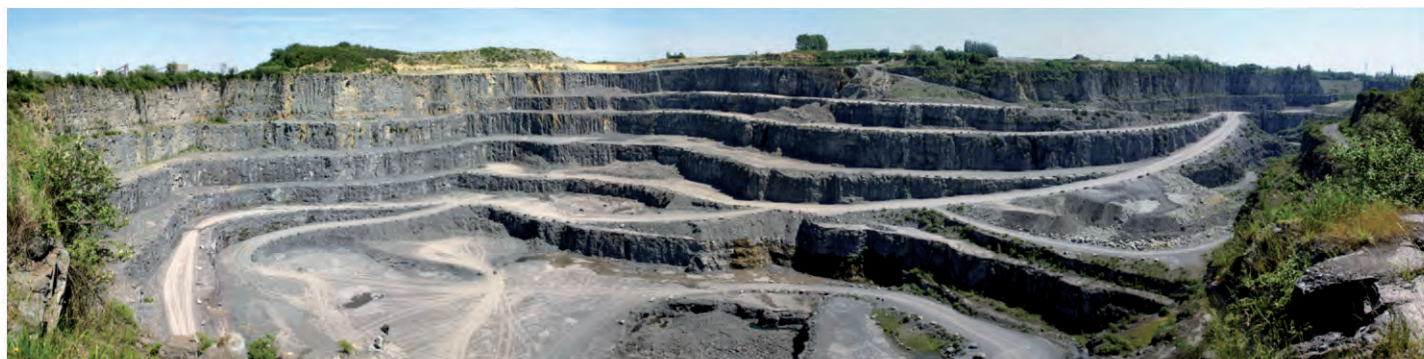
Front de taille exploitant le calcaire carbonifère sur 7 paliers (carrière d'Antoing dans le Tournaisis).
