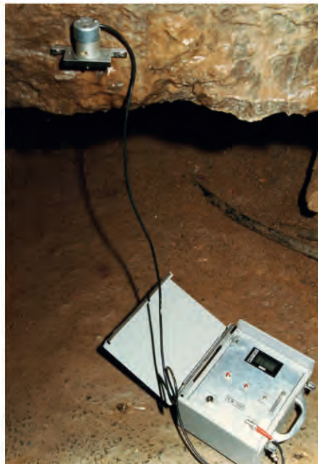
Sismographe et suivi de l'état de la grotte (photo J.-P. Bartholeyns).
