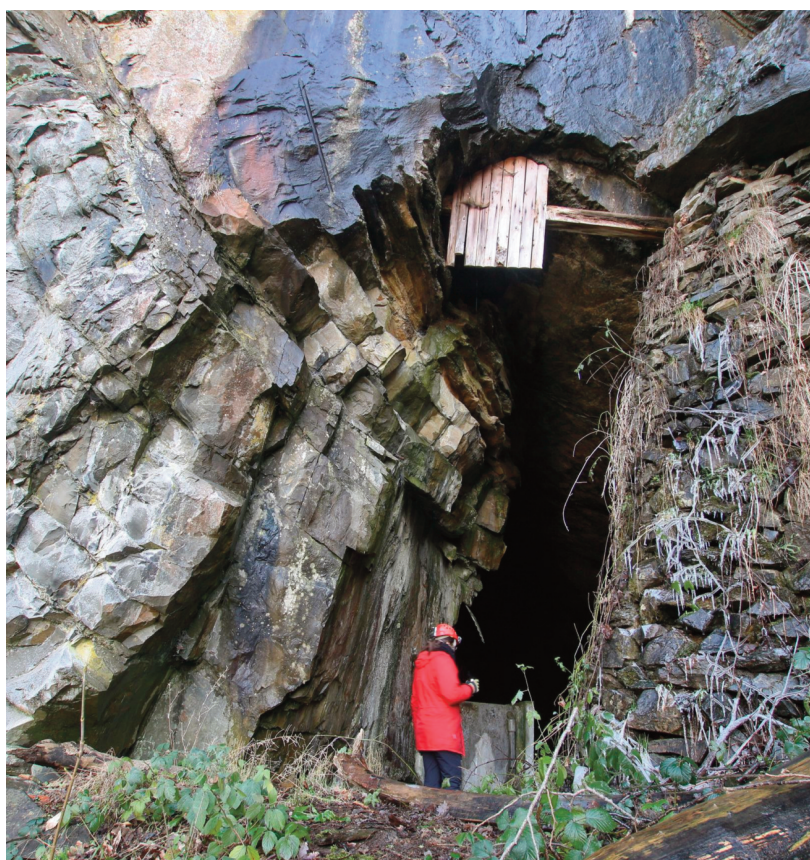
Fig 1. L'entrée de l'ancienne carrière souterraine laisse voir un grès plissé et même faillé au-dessus de la « porte ».
