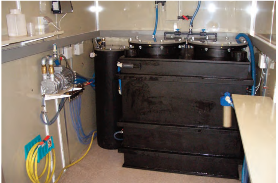
Fig. 3 – Unité Mobile de Bioremédiation conçue et mise en œuvre par Sanifox
