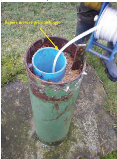
Piézomètre manuel, avec descente d'une sonde graduée pour mesurer la profondeur de la nappe (photo C. Rentier).
