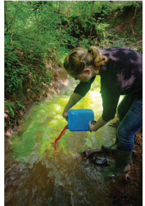
Figure 4: Injection directe de 80 g de fluorescéine dans le ruisseau en amont du chantoir de Kin (photo L. Remacle).
