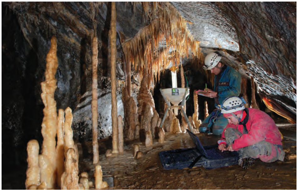
Figure 2 – Station d'étude de percolations au sein de la zone non-saturée dans la grotte du Père Noël (Han-sur-Lesse). Les scientifiques du département de géologie de l'Université de Namur y effectuent le monitoring du débit de stalactites ainsi que de paramètres tels que la température et le chimisme de l'eau (Photo G. Rochez, 2014).
