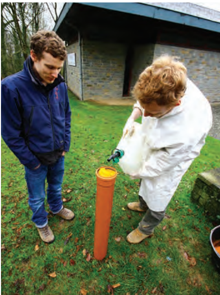
Figure 3 – Lors d'un essai de traçage en zone non-saturée, la substance traçante est injectée directement à la surface du sol. Trente mètres plus bas, dans la grotte de Rochefort, la restitution du traceur dans l'eau de percolation est mesurée de façon continue afin d'obtenir des indications précises sur les processus d'infiltration entre la surface et la cavité (Photos A. Watlet et A. Poulain, 2016).
