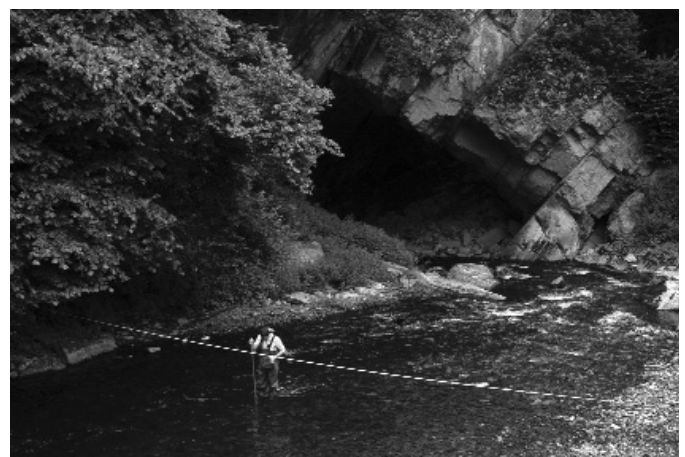
Mesure de débit au gouffre de Belvaux (photo FUNDP Namur)
