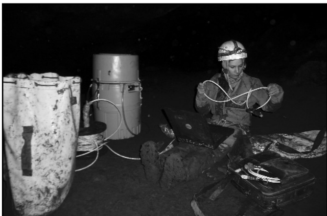
Placement d'un échantillonneur automatique dans le réseau Sud des grottes de Han lors d'un traçage (Photo FUNDP Namur)
