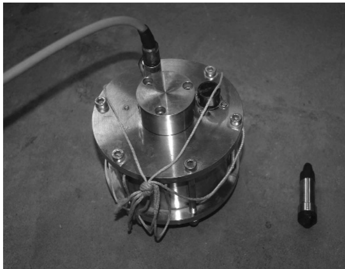
Fluorimètre et sonde pressiométrique, placés dans certains cours d'eaux souterrains pour suivre en continu les variations de la hauteur d'eau (permettant de calculer le débit) et la concentration de traceurs dans les eaux. - Photo FUNDP Namur
